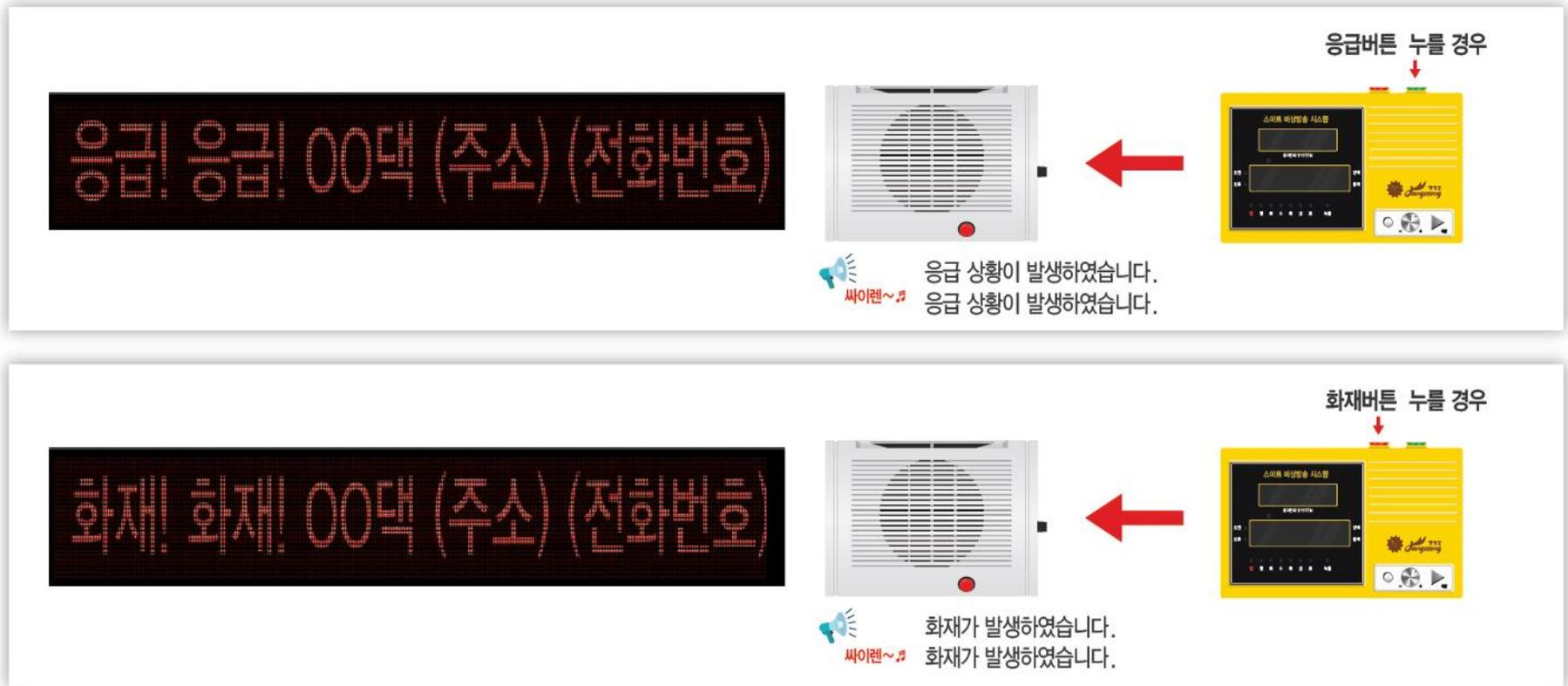
○ 응급 및 화재 상황 발생 시 전광판을 통해 구호 대상자의 주소 등의 정보를 알려주고, 스피커를 통해 알림 방송이 송출됩니다.
